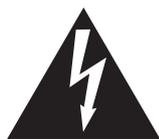
Символ молнии внутри равностороннего треугольника предупреждает о наличии внутри устройства неизолированного высокого напряжения, которое может вызвать поражение электрическим током.
