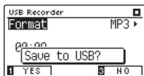
Нажмите ФУНКЦИОНАЛЬНУЮ кнопку (YES) для подтверждения операции сохранения или ФУНКЦИОНАЛЬНУЮ кнопку (NO) для отмены действия.
