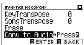
Нажмите ФУНКЦИОНАЛЬНУЮ кнопку **2** (ENTER), чтобы выбрать функцию Convert to Audio.
